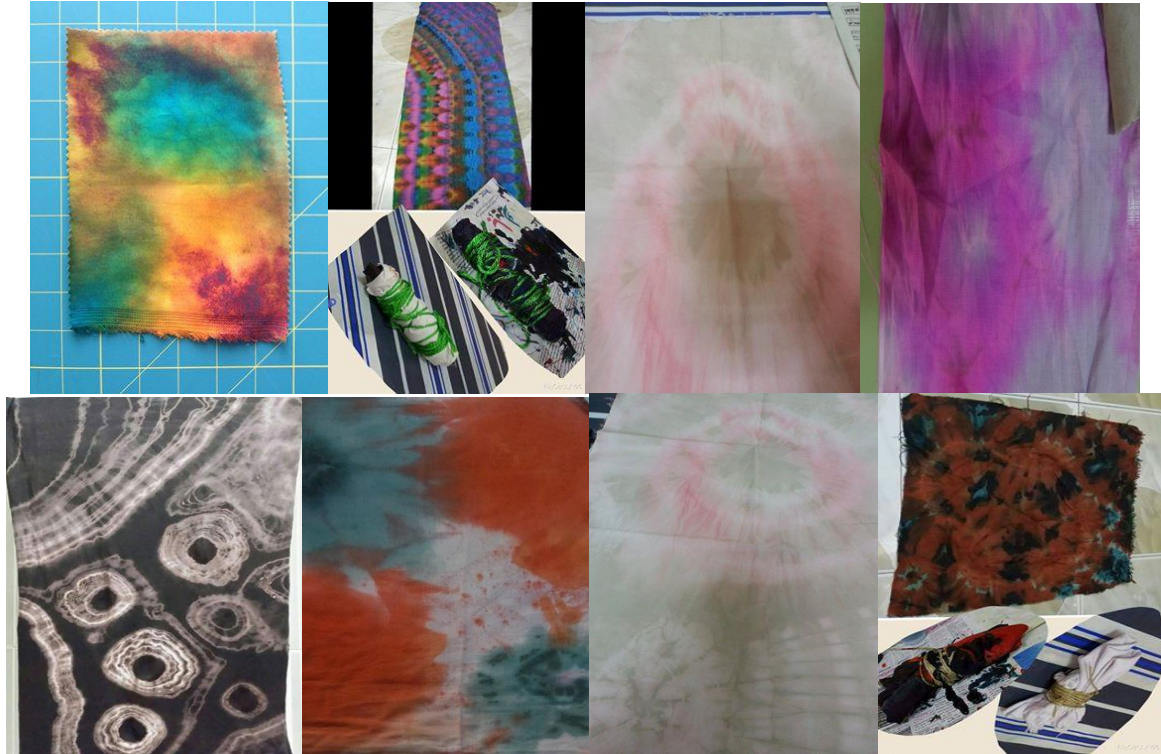
نتائج التدريب على طريقة (العقد و الربط) عينات لأقمشة مختلفة في التركيب النسجي و نسبة الخلط ( طبيعية - نصف طبيعية) باستخدام الصبغات النشطة مع استعراض النتائج و تحليلها وذلك بعد اجراء عملية تثبيت الصبغة و تمام جفاف العينة
